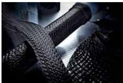
Tandis que les cadres en carbone étaient jusqu'à présent empilés, usinés et collés à la main à partir de nattes, la fabrication chez BMC est aussi précise et fluide que chez un horloger suisse. Dans la "Stargate", chaque pièce du cadre est tressée en un tout autour du noyau positif. Plus de 100 bobines de fils fins traversent la roue de tressage à une vitesse époustouflante pour créer en quelques secondes un tube sans soudure souple en fibres de carbone. À ce stade,
