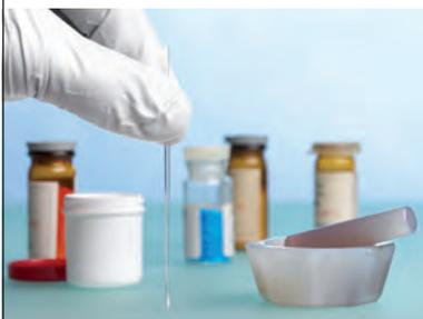
Préparation de l'échantillon : la poudre séchée d'urée est broyée dans un mortier et introduite dans les capillaires avant insertion dans le four.
