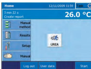
Page d'accueil du MP50. Le mode d'exploitation « Pharmacopée » est défini dans l'appareil. Une fois programmé, le raccourci de la méthode « Urée » peut être utilisé de façon récurrente pour lancer la mesure.
